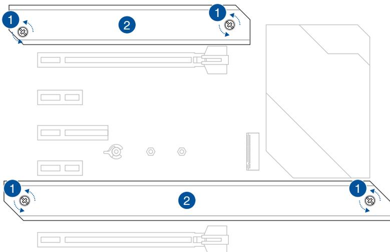
3. Installez votre module M.2 dans le slot M.2. Les étapes d'installation peuvent différer selon la longueur du module M.2, référez-vous aux procédures d'installation adaptées aux différents types de lecteurs M.2 :
