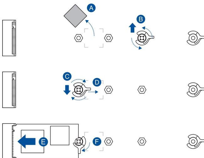
• **Pour installer module M.2 dans le slot M.2\_2**
